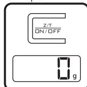
Нажмите кнопку Z/T/ON/OFF, чтобы включить весы. Подождите, пока весы стабилизируются. На дисплее должна появиться индикация «О».
