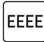
Индикатор перегрузки сообщает о превышении допустимой нагрузки. При появлении этого индикатора немедленно уберите нагрузку с весов, чтобы не допустить их повреждения.
