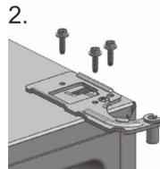
2) С помощью отвертки открутите крепежный винт верхней правой петли и снимите шарнир.
