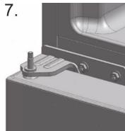
7) Снимите вал средней петли, поверните среднюю петлю на 180 градусов, закрутите вал, затем установите морозильную дверь и установите среднюю петлю влево (вертикальное направление вала петли после замены двери такое же, как и раньше).
