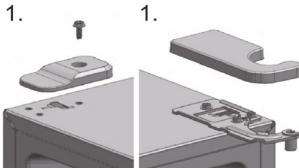
1) Снимите левую и правую крышки петли. Левая крышка петли(малая) зафиксирована винтом. Правая крышка защелкнута на защелки.
