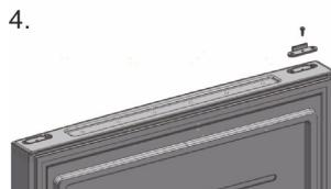
4) Снимите дверь морозильной камеры. На нижней стороне двери есть стопор металлический, необходимо его установить согласно требованиям открытия(левое или правое). Такие же операции с дверью холодильной камеры.
