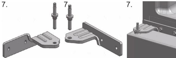
7) Снимите вал средней петли, поверните среднюю петлю на 180 градусов, закрутите вал, затем установите морозильную дверь и установите среднюю петлю влево (вертикальное направление вала петли после замены двери такое же, как и раньше).
