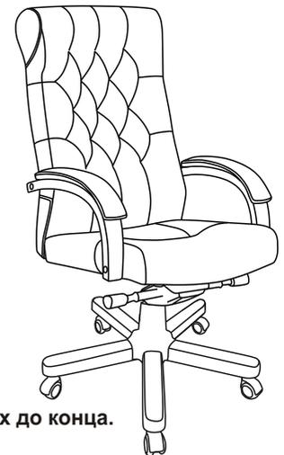
**Примечания:** Шаг 2. Снять защитный колпачок с газлифта, в случае его наличия. Шаг 3 - 4. Вставить и закрутить винты поочередно, не затягивая их до конца. После выполнения шага 4 закрутить все винты до полной фиксации.
