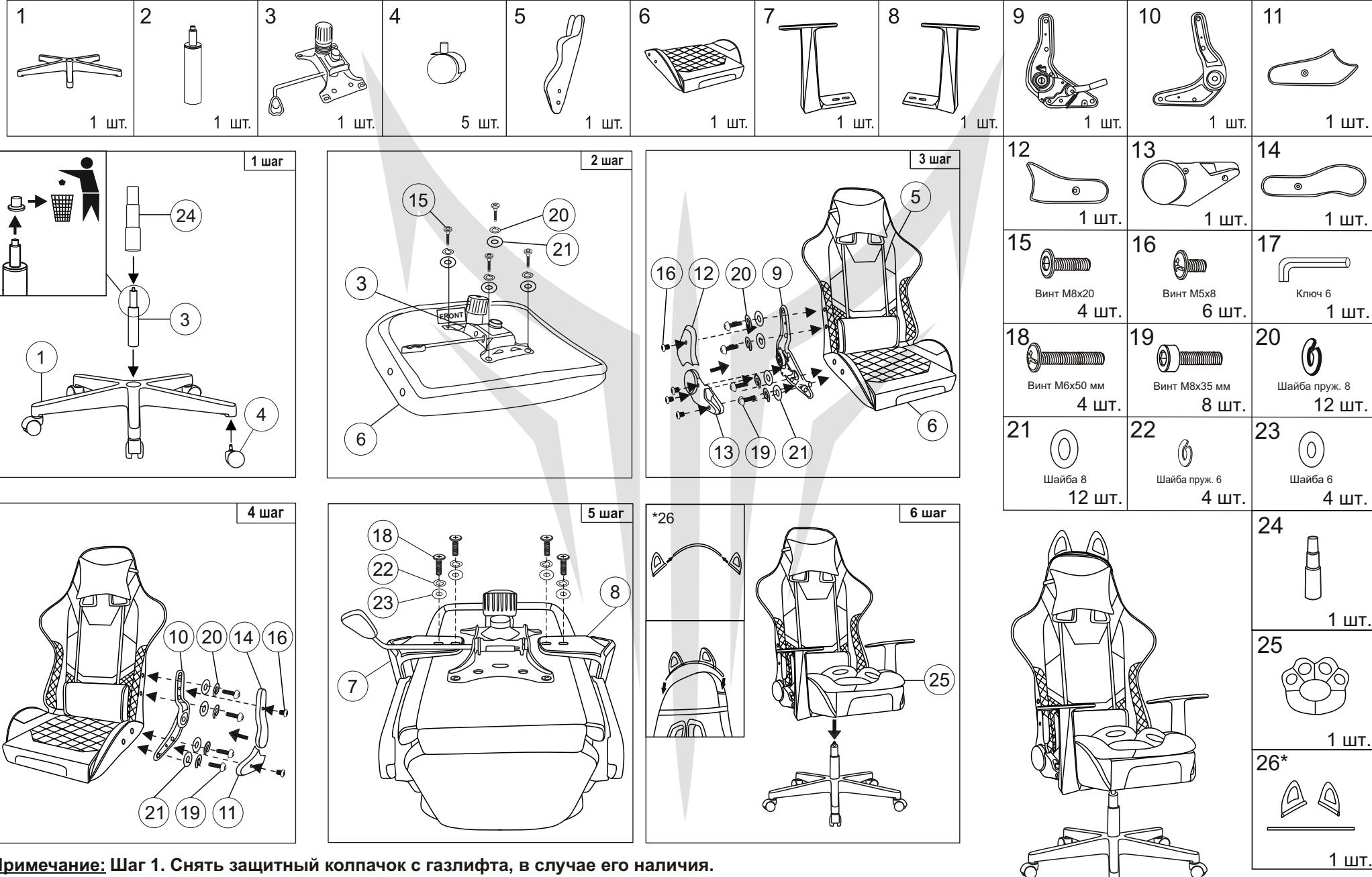
**Примечание:** Шаг 1. Снять защитный колпачок с газлифта, в случае его наличия.
