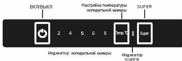
**ВКЛ/ВЫКЛ** - нажатием данной кнопки можно включить весь прибор в целом (как холодильную, так и морозильную камеру). Для отключения холодильника достаточно нажать кнопку.
