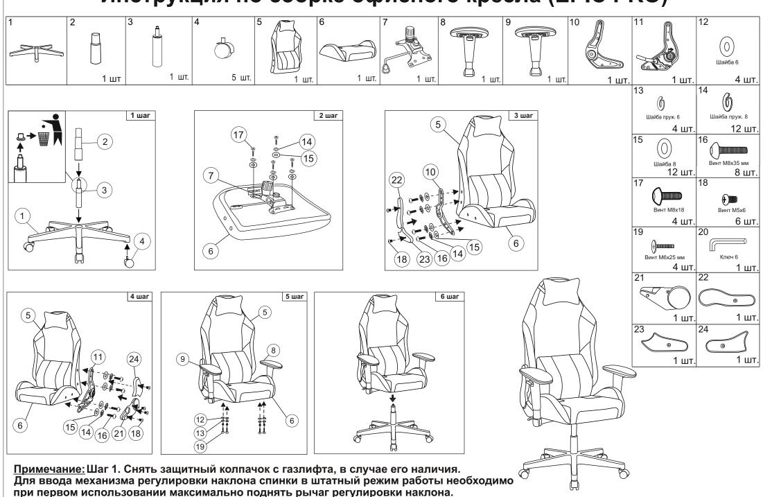
Деталь поз. 11 устанавливается под левую или правую руку в зависимости от комплектации.
