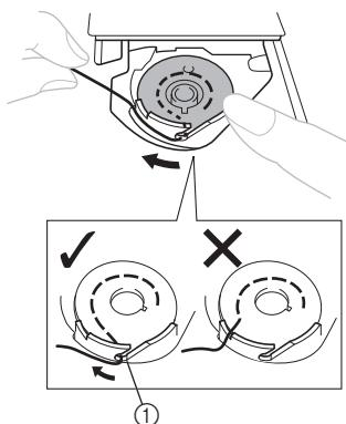
① Пружина регулировки натяжения нити
