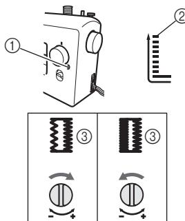
① Винт точной настройки обметывания петель
