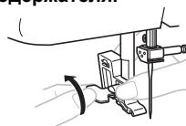
**4** Отверткой выверните два винта. Поднимите игольную пластину, как показано на рисунке, и затем сдвиньте игольную пластину влево, чтобы снять ее.
