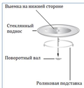
На поворотный вал устанавливается стекланный поднос. Под стекланный поднос устанавливается роликовая подставка, которая помогает подносу свободно вращаться. Вращение пищи во время работы печи способствует ее равномерному приготовлению.
