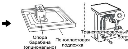
Снимите транспортировочные болты и опоры.
