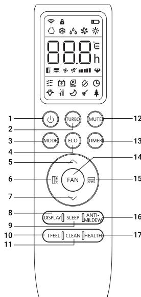
1. Кнопка ON/OFF – включення / вимикання.
