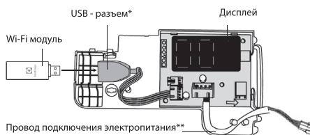
\* Разъем для подключения Wi-Fi модуля
