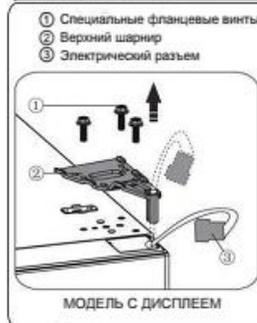
4. Приподнимите верхнюю дверцу и аккуратно снимите со среднего шарнира. Поставьте дверцу на мягкую поверхность верхней крышкой вверх.
