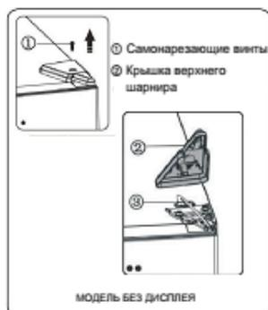
3. Открутите винты 1 и снимите шарнир 2. Модель с дисплеем: извлеките провод разъема 3 через отверстие шарнира 2. (Придерживайте верхнюю дверь рукой).
