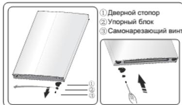
8. Открутите винты, фиксирующие средний шарнир, и снимите шарнир. Снимите нижнюю дверь.
