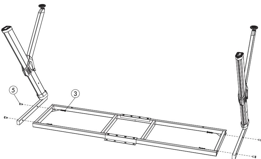
Прикрепите ножки к бокам с помощью двух винтов M6 (5) с наружной стороны и двух винтов M6x30 (3) – с внутренней.
