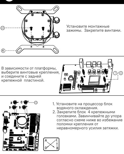
1. Установите заднюю крепежную пластину
