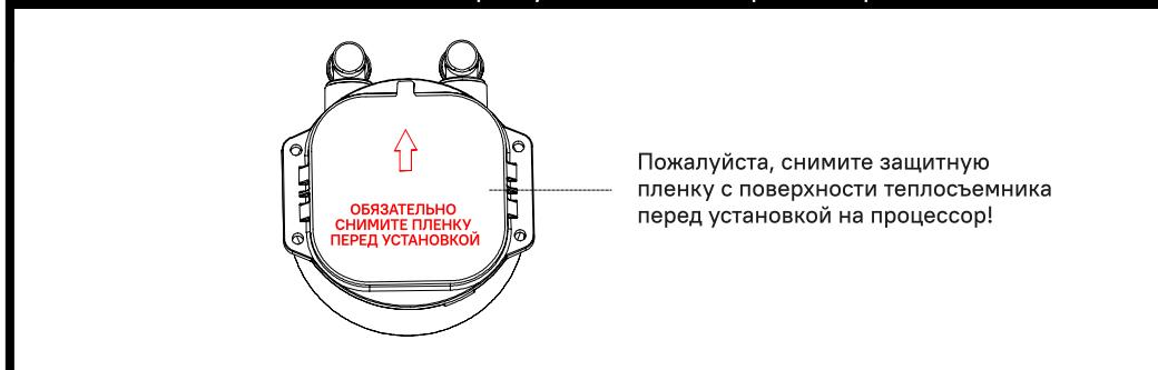
Пожалуйста, снимите защитную пленку с поверхности теплосъемника перед установкой на процессор!
