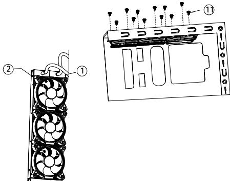
Рекомендуем устанавливать СЖО в верхней части корпуса. Фиксация радиатора к корпусу ПК осуществляется короткими винтами.
