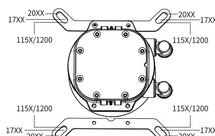
Пожалуйста, ознакомьтесь с положением монтажных отверстий материнских плат разных сокетов относительно монтажных зажимов.
