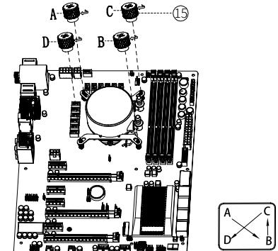
Установите на процессор блок водяного охлаждения.
