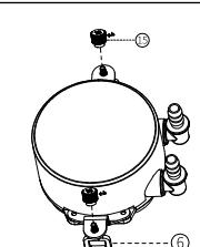
Прикрепите монтажные скобы к монтажным зажимам и зафиксируйте крепежными головками.
