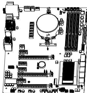
После того, как вы установили водоблок на процессор и защелкнули монтажные скобы на креплении материнской платы, закрутите до упора крепежные головки.
