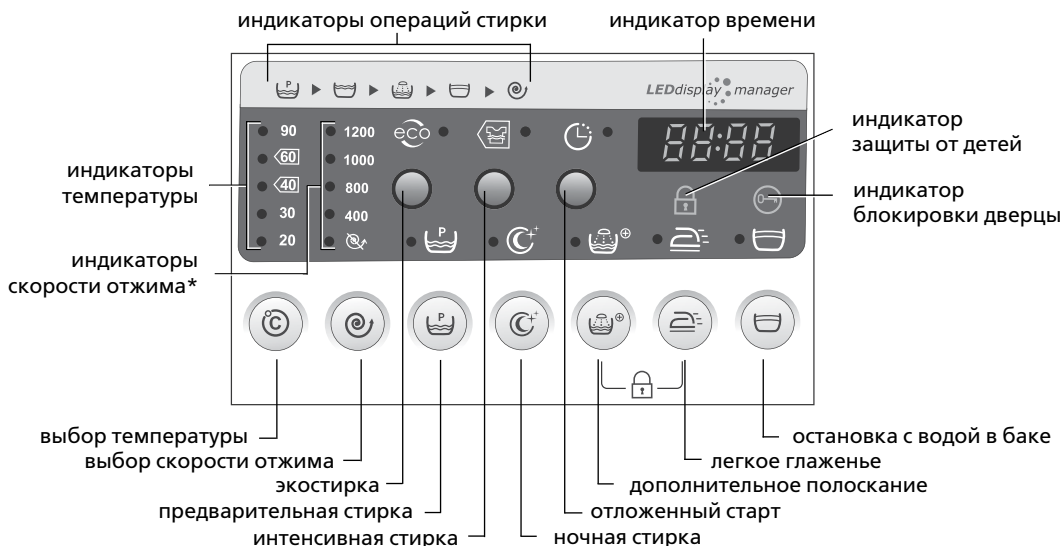
Рисунок 3 — Зоны индикации и кнопки выбора дополнительных функций
