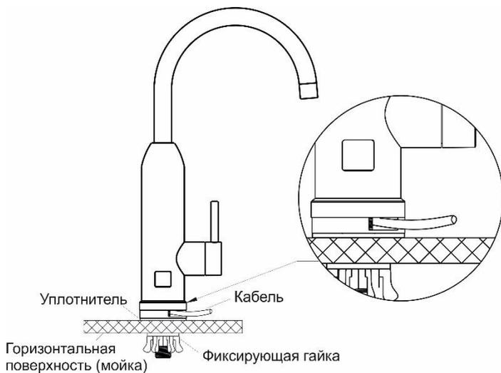
Рис. 1. Установка с выводом кабеля питания над мойкой
