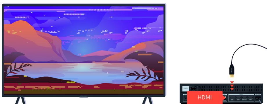
Если внешнее устройство поддерживает видео в формате 4K UHD или 8K UHD, используйте для каждого разрешения специальный кабель HDMI.
