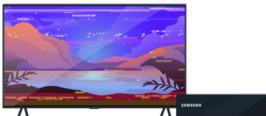
Проверьте подключение антенны и кабеля входного сигнала.
