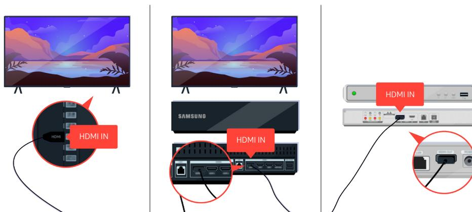
Если проблема не исчезает, попробуйте подключить к телевизору другое устройство с помощью кабеля HDMI. Если изображение на экране нормальное, неисправность связана с внешним устройством.
