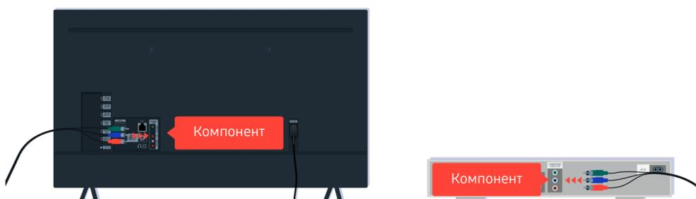
Если используется компонентный кабель, убедитесь, что цветные коннекторы подключены к разъёмом соответствующих цветов на внешнем устройстве и телевизоре.
