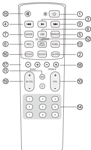
1. ⏹ Кнопка включения микросистемы / перевода ее в режим ожидания (краткое нажатие) / включения/выключения подсветки (продолжительное нажатие)
