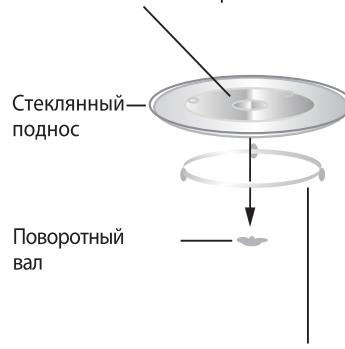
На поворотный вал устанавливается стеклянный поднос. Под стеклянный поднос устанавливается роликовая подставка, которая помогает подносу
