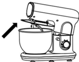
Нажмите кнопку разблокировки корпуса, чтобы его поднять.
