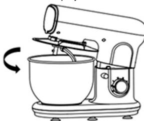
Вставьте нужную насадку в разъем, прижмите и поверните ее против часовой стрелки до упора.
