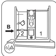
Положение **B** перегородки для моющих средств предназначено для порошковых моющих средств в заднем отделении, а также для жидких моющих средств/добавок или отбеливателя в переднем отделении.
