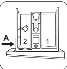
Положение **A** перегородки для моющих средств предназначено для **порошкового моющего средства**.
