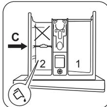
Положение **C** перегородки для моющих средств предназначено для жидкого моющего средства.
