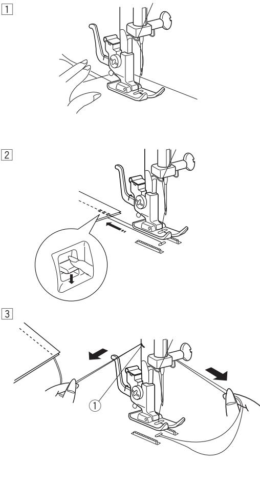
1 Поднимите прижимную лапку и расположите ткань в соответствии с направительными линиями на игольной пластине. Опустите иглу в ткань. Опустите прижимную лапку и отведите нити назад. Нажмите на ножную педаль. Слегка только направляйте ткань вдоль линий на игольной пластине, ткань должна сама проходить под лапку.
