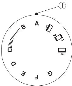
Поднимите иглу и прижмите лапку. Совместите символ нужной строчки с установочной отметкой на панели, повернув регулятор выбора строчек.
