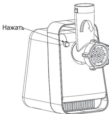
Чтобы снять камеру мясорубки, одной рукой нажмите на кнопку для установки и снятия камеры, а другой возьмитесь за камеру и поверните ее по часовой стрелке.
