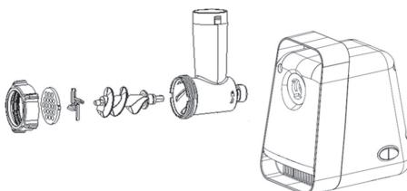
2. Вставьте шнек в камеру мясорубки длинным концом внутрь. Слегка поверните шнек, чтобы зафиксировать его в корпусе мясорубки.
