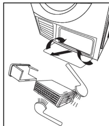
9. Закройте крышку отсека для обслуживания, зафиксировав ее в нужном положении.
