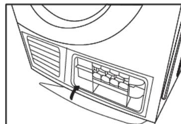
Пожалуйста, очищайте теплообменник примерно раз в 3 месяца, при частом использовании устройства. Не повредите теплообменник во время чистки! Очистка теплообменника должна производиться только с помощью воды, без использования острых или твердых предметов.
